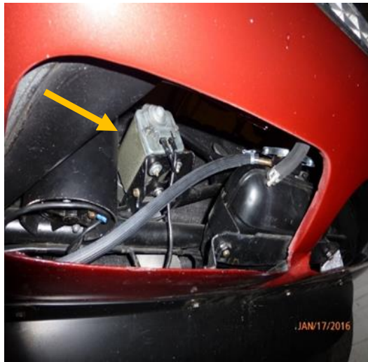
15) Lucas square radiator fan motor
