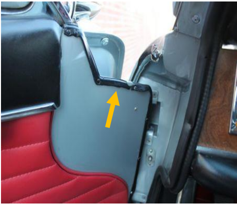
4) rubber molding on door
