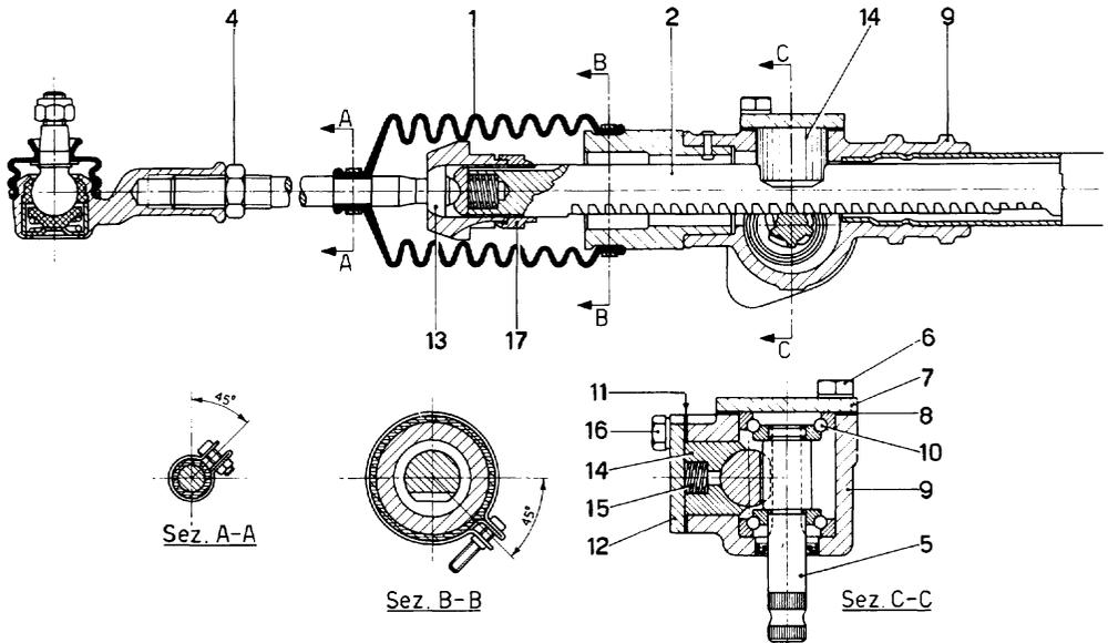
la distanza tra il corpo guida 9 e la flangia 7 e adattare un distanziale con spessore di mm  $0,05 \pm 0,13$  superiore alla distanza rilevata. Rimontare flangia e distanziale con mastice per la tenuta olio e bloccare i bulloni 6. Il pignone deve girare libero senza traccia di gioco assiale.
