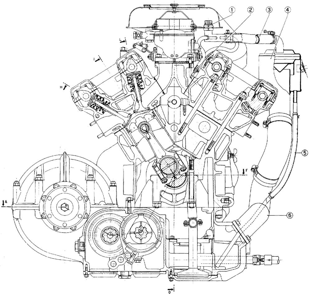
33) Sezione trasversale del motore e schema per riciclo gas dal basamento.
