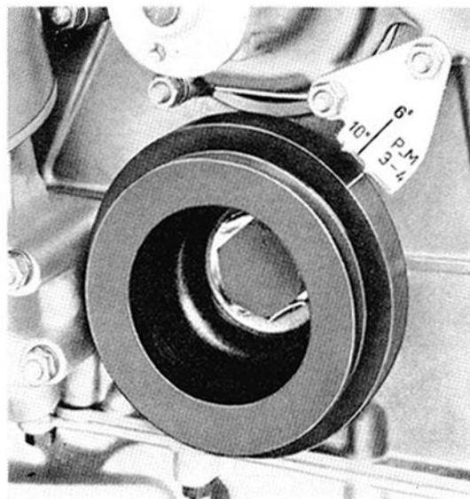
23) Orientamento puleggia sull'albero motore per il controllo fasatura P.M. 3-4. Punto morto superiore dei cilindri 3-4.
