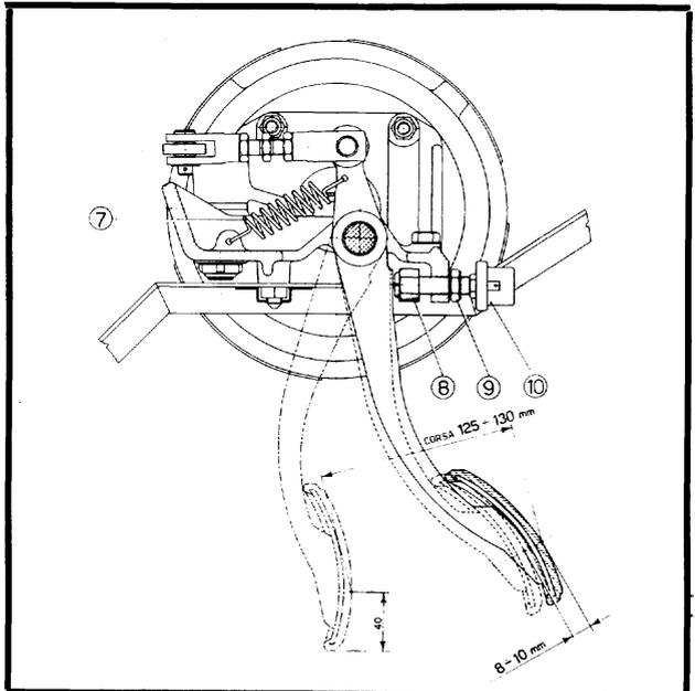
dale freno è di mm 125 ÷ ÷ 130, misurata in prossimità della mezzeria della piastra di appoggio sulla leva.
