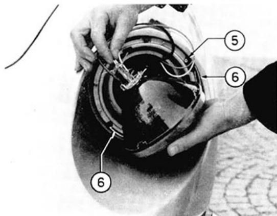
**69) Sostituzione lampada proiettore.**
