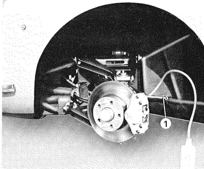
e perpendicolari all'asse di rotazione, soprattutto quando il disco è montato sul proprio mozzo. L'errore tollerabile non deve superare i mm 0,08.
