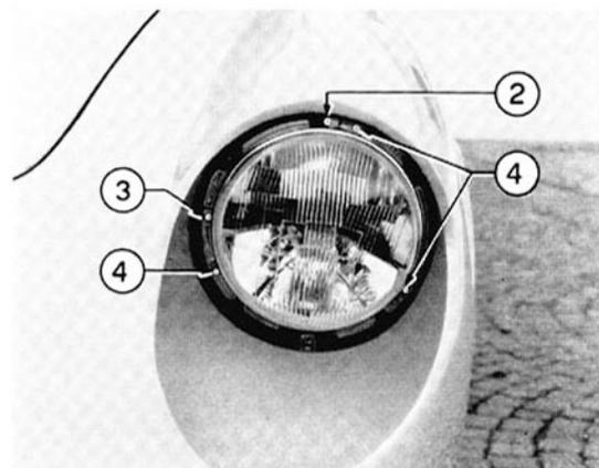
**68) Viti di orientamento e fissaggio.**
