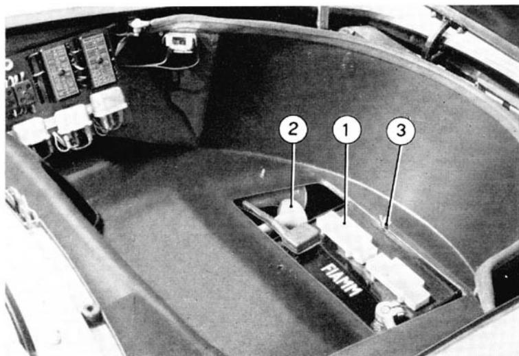
— Mantenere la batteria asciutta e pulita esternamente. **Ogni 2.500 km**, a batteria fredda, controllare che il livello dell'elettrolito affiori dal foro in fondo al pozzetto di ciascun elemento. Per ripristinare il livello usare esclusivamente acqua distillata e senza acido. — Nella stagione estiva controllare più sovente.
