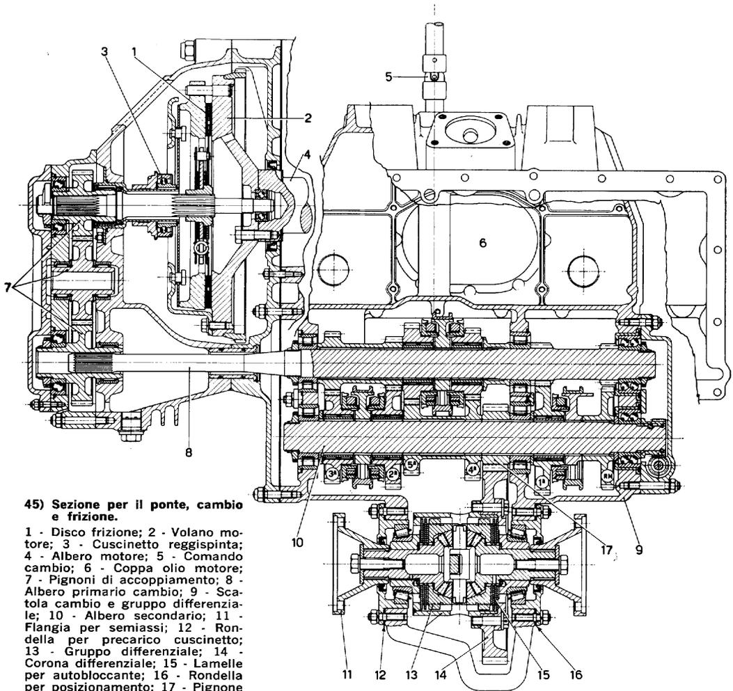
**45) Sezione per il ponte, cambio e frizione.**
