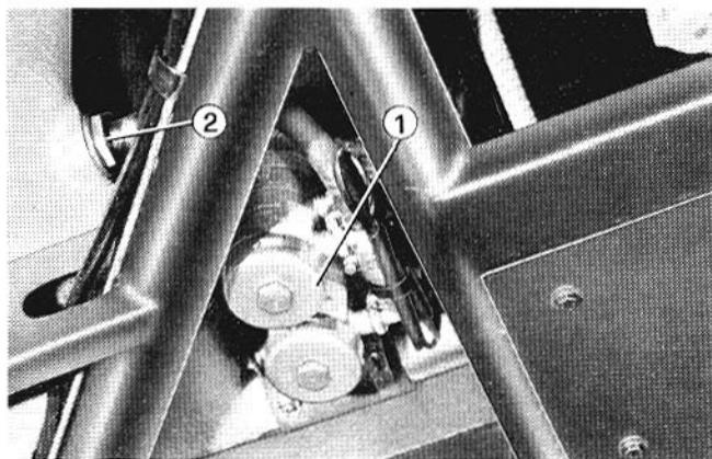
**27) Sistemazione delle pompe Bendix sulla vettura.**
