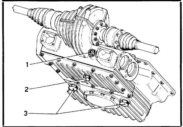
re caldo, scaricare completamente l'olio. Sostituire pure il filtro usando lo speciale attrezzo in dotazione e controllare che dopo la sostituzione non vi siano perdite. Quando non si usa olio **SHELL SUPER M. O. «100»** sostituire olio e filtro ogni **5.000 km.**
