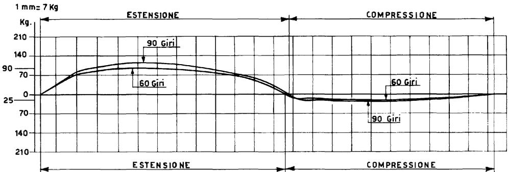
51) Ammortizzatori posteriori. Diagramma di taratura: Estensione kg 90 - Compressione kg 90.
