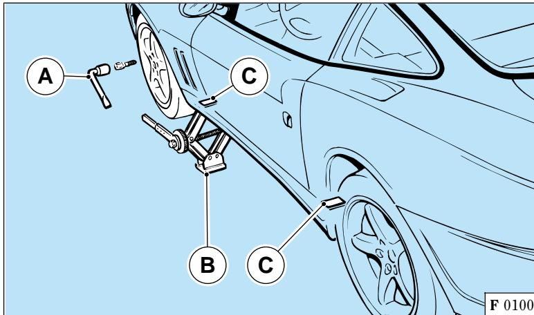
**Fig. 25 - Sostituzione ruota**
