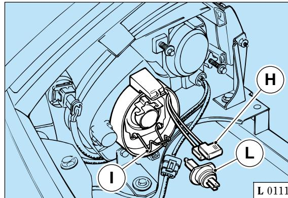
**Fig. 6 - Sostituzione lampada luce abbagliante e luce anabbagliante.**
