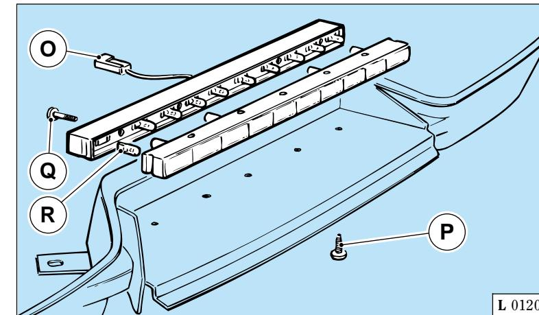
Fig. 14 - Remplacement de la lampe du feu de stop supplémentaire.
