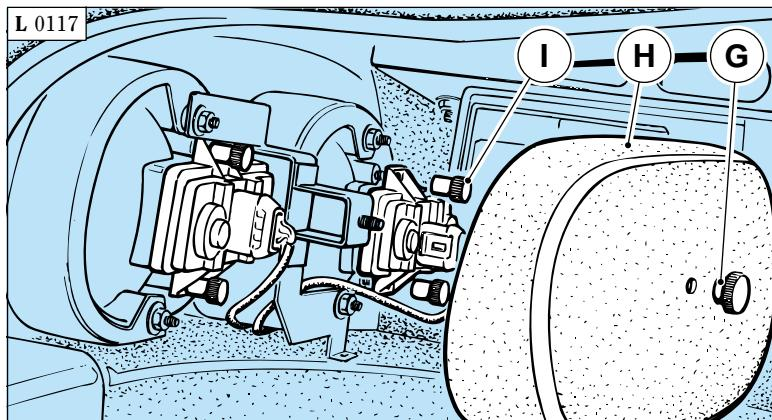
Fig. 12 - Sostituzione lampada
