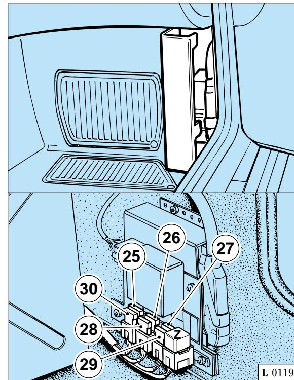
Fig. 15 - Boîtier sous le repose-pied côté passager.
