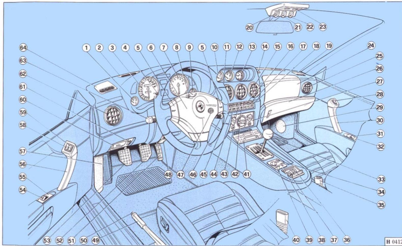
**Fig. 1 - Apparecchi di controllo e comandi**
