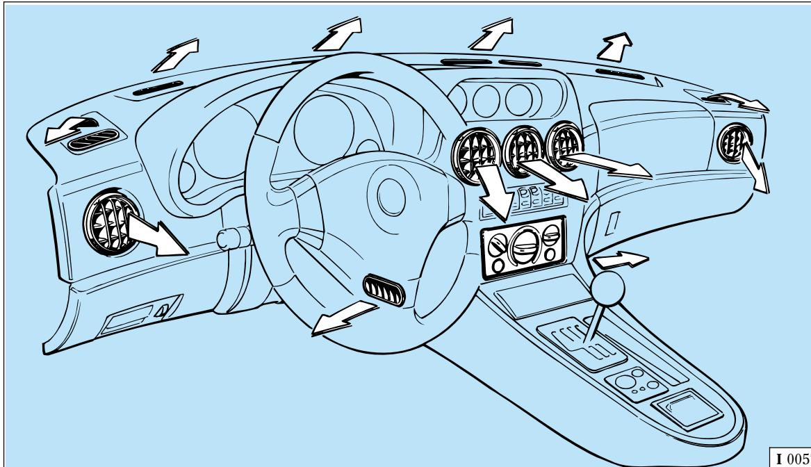
Fig. 33 - Ventilazione interno vettura.
