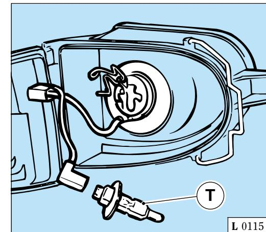
Abb. 10 - Ersatz der Nebelscheinwerferlampe.
