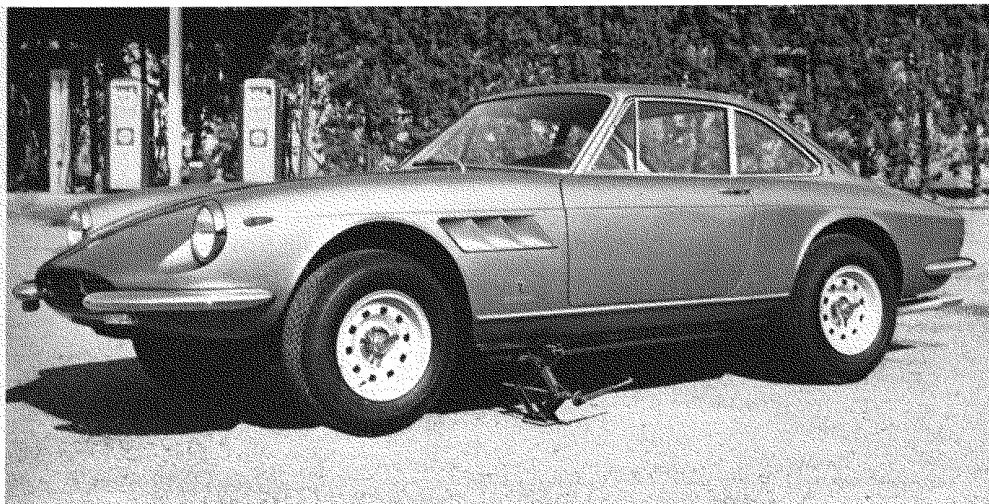
17) Sollevamento ruota anteriore con martinetto.
