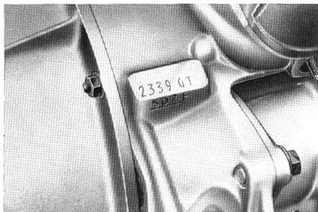
Fig. 3 - Numero di identificazione del motore.
