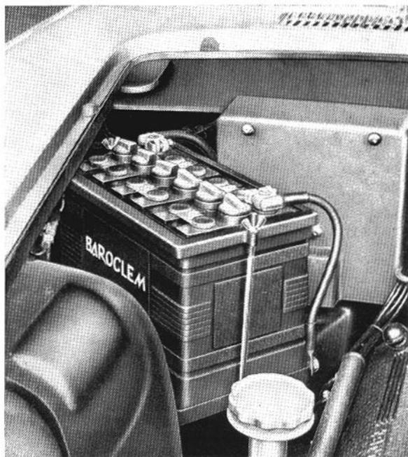
Fig. 63 - Sistemazione della batteria nella vettura.
